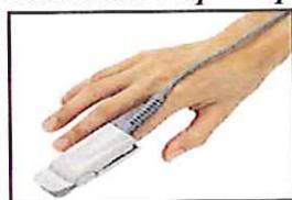
Il est composé de deux diodes : l'une émet dans le rouge et l'autre dans l'infra-rouge ; ces deux lumières traversent les capillaires sanguins de l'extrémité du doigt et sont absorbées différemment en fonction des quantités de Hb et  $\text{HbO}_2$  présentes dans le sang ; la mesure des intensités reçues par le détecteur permet de remonter à la valeur de la saturation en oxygène.
