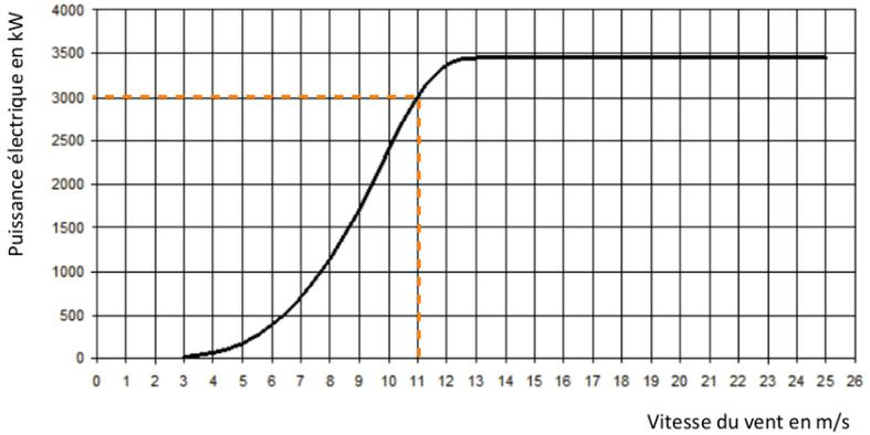
Quand le vent est de 11 m/s la puissance de l'éolienne est 3 000 kW.
