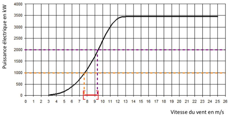
La puissance sera comprise entre 1000 et 2000 kW si la vitesse est comprise entre  $7,5 \text{ m} \cdot \text{s}^{-1}$  et  $9,5 \text{ m} \cdot \text{s}^{-1}$ .
