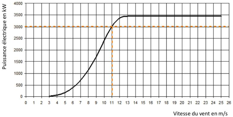
La puissance de l'éolienne est supérieur à 3 000 kW si la vitesse du vent est supérieure à  $11 \text{ m} \cdot \text{s}^{-1}$ .
