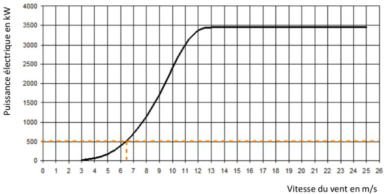
La puissance est supérieure à 500 kW à partir de 6,5 m · s<sup>-1</sup>.
