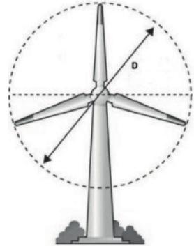
D'après les principes de la mécanique, la valeur maximale du coefficient de performance  $C_p$  est  $\frac{16}{27}$ .
