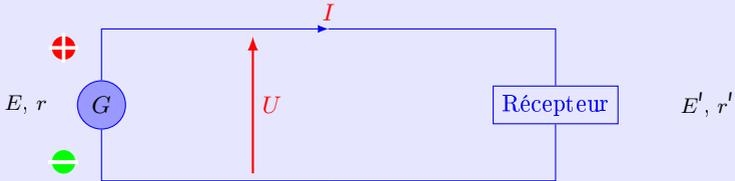
Dans le circuit ci-dessus, le générateur possède une force électromotrice  $E$  et une résistance interne  $r$ . La tension  $U_1$  à ses bornes est une fonction affine de l'intensité  $I$  du courant électrique selon la formule  $U_1 = E - rI$ .
